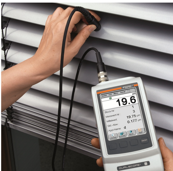
Abb. 1: Messung der Lackdicke auf Jalousien mit der Sonde FTD3.3 und dem Messgerät DUALSCOPE® FMP100
