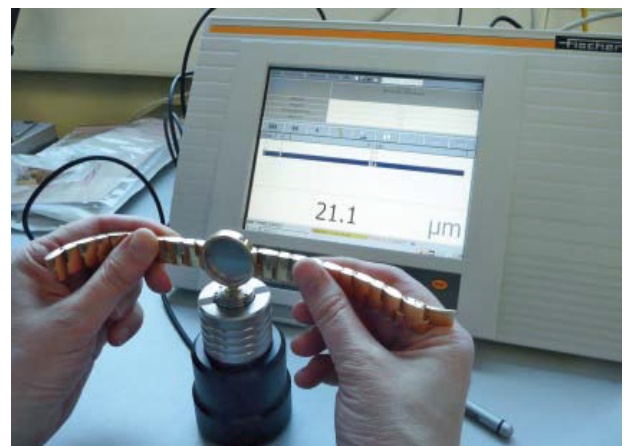
Abb. 2: Schichtdickenmessung an einem vergoldeten Uhrengehäuse mit dem FISCHERSCOPE ® MMS ® PC2 BETASCOPE ®
